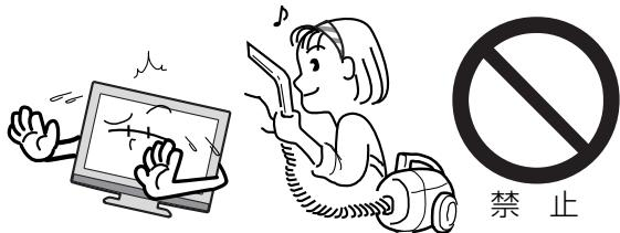
**ときどきは電源コンセントや電源プラグの点検**を長い間コンセントに電源プラグを差し込んだままにしておくと、ほこりがたまり、湿気が加わることで漏えい電流が流れ、**火災の原因**となることがあります。
