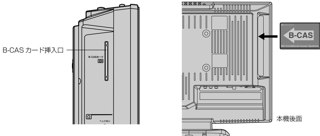
B-CASカードの挿入時は、本機の電源プラグを電源コンセントに接続しない状態で挿入する。絵表示が見える面を本機後面側にして、B-CASカード表面の矢印の向きを挿入口に合わせ、奥までゆっくりと押し込んでください。
