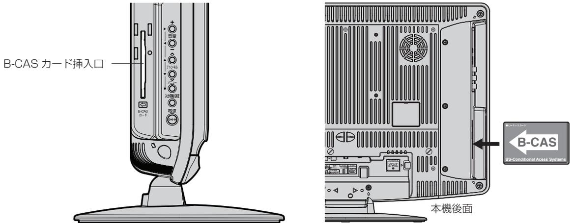
B-CAS カードの挿入時は、本機の電源プラグを電源コンセントに接続しない状態で挿入する。絵表示が見える面を本機後面側にして、B-CAS カード表面の矢印の向きを挿入口に合わせ、奥までゆっくりと押し込んでください。
