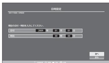
▲/▼/◀/▶ で修正が必要な入力フィールドへ移動し**決定**を押す。▲/▼ で日時を修正し、**決定**を押す。入力が完了したら ▲/▼/◀/▶ で「次へ」を選び、**決定**を押す。
