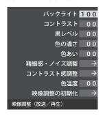
3 以降の手順(→ 64 まで)でお好みの映像に調整する 他の項目を調整するときは、手順2から繰り返しま す。(「黒レベル」、「色の濃さ」、「色あい」 などのように、調整時に▲▼で調整項目を切り換 えられる項目もあります)
