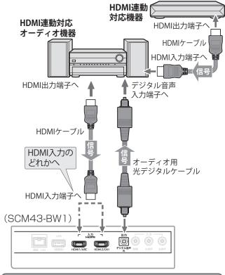
※ ARC対応のオーディオ機器を、ARC対応のHDMIケーブルでHDMI入力1(ARC)端子に接続する場合は、デジタル音声ケーブルの接続は不要です。
