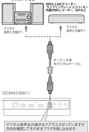
※デジタル音声ケーブルのプラグには2種類の形状があります。接続する機器の端子形状に合ったケーブルをお買い求めください。本機側に差し込むプラグの形状は、 です
