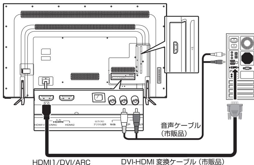
パソコンの音声を本機のスピーカーで聴く場合は、HDMI1/DVI/ARC 入力端子と接続し、メニューのビデオ音声入力設定を HDMI1 アナログ音声に切り換えます。(55 ページの「ビデオ音声入力設定」を参照してください。)
