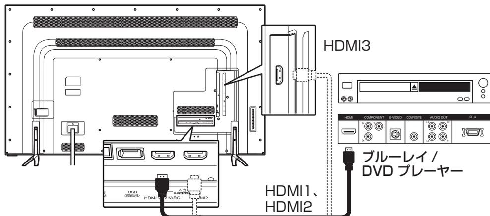
本機は 4K 解像度の入力に対応しています。4K 映像を視聴する際は、HDMI3 (4K) 入力端子に接続してください。また本機の HDMI1 / DVI / ARC 入力端子は HDMI ARC (オーディオリターンチャンネル) に対応しています。
